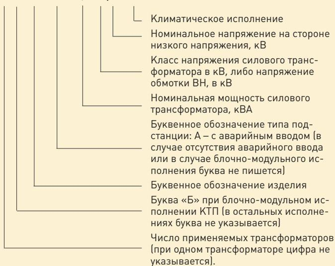
Пример условного обозначения типа КТП двухтрансформаторной, автоматизированной, мощностью 400 кВА, класса напряжения 10 кВ, на номинальное напряжение на стороне низкого напряжения 0,4 кВ, климатическое исполнение УЗ\* (04) при заказе и в документации другого изделия:
